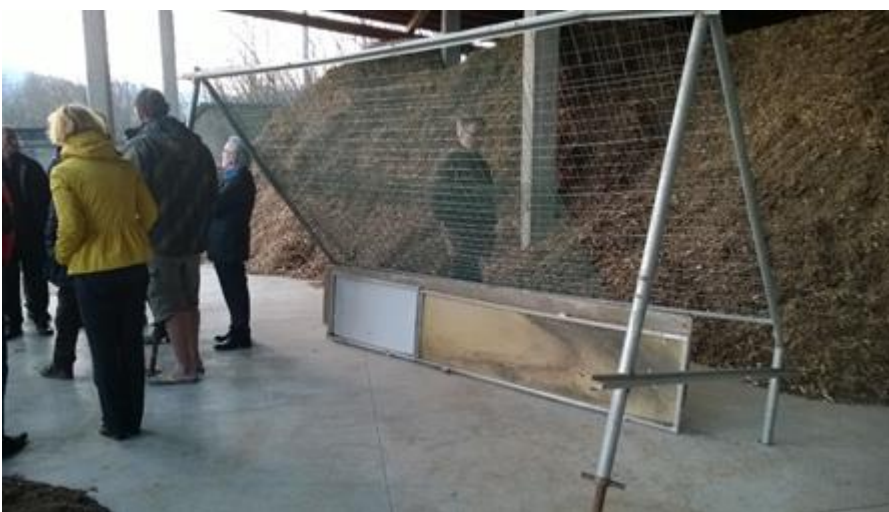
Kuva 3. Popolin hakevarastolla hake seulotaan metalliverkon läpi hienojakoisen lehtimassan erottamiseksi.
