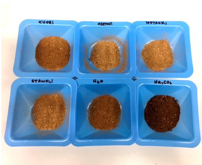
Kuva 8. Uutettu ja kuivattu kuorijauhe (alkuperäinen kuori, asetoni, metanoli, etanoli, vesi, sooda).
