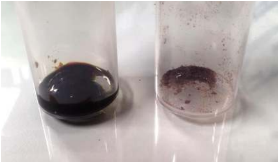
Kuva 10. Metanoli vs. vesiutteen jäännössakka. Metanoli viskoosi tahna vs. vesi jauhemainen kiinteä sakka.
