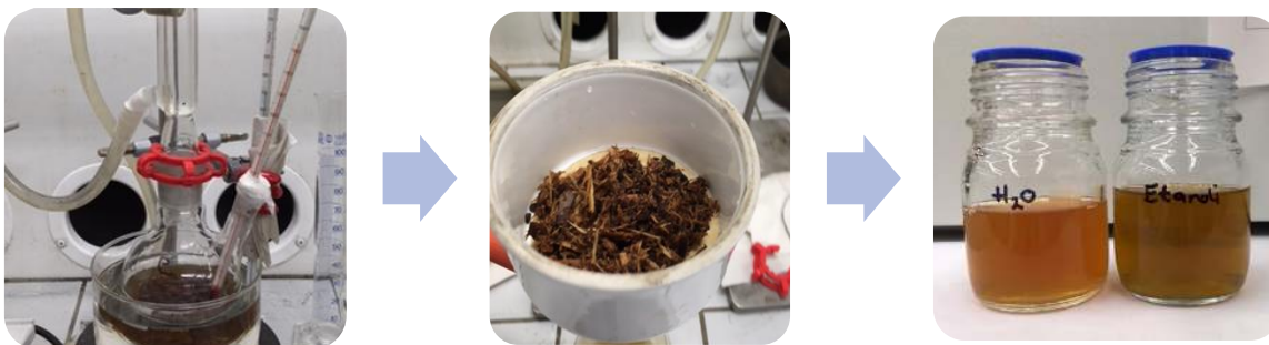
Kuva 2. Männyn kuoren uutto refluksointimenetelmän avulla, uutettu kuori sekä suodatetut uuteaineet jatkoanalysointia varten.
