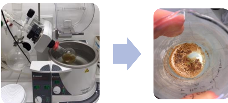
Kuva 3. Liuottimen haihdutus ja uuteaineiden erotus pyöröhaihduttimella.
