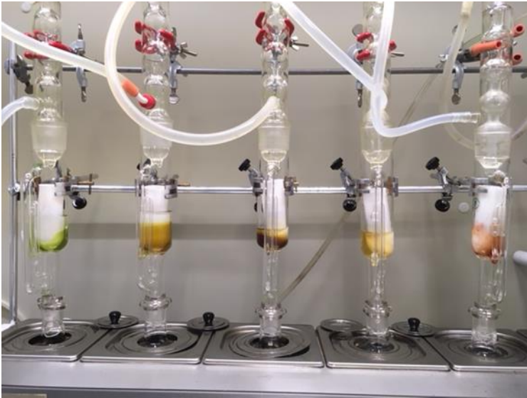
Kuva 4. Soxhlet uuttolaitteisto. Liuottimena vasemmalta lähtien asetoni, metanoli, etanoli, vesi ja sooda.
