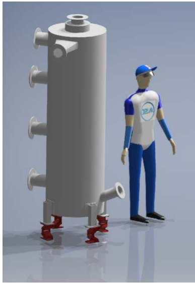
Kuva 3. Hitaan pyrolyysin prosessilaite, tekninen toteutus ja mittakaava.
